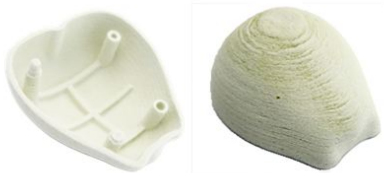
Graphique 5.1. Pièce imprimée de façon expérimentale par projection de liant
